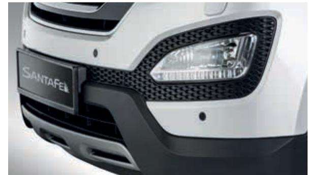
**Funk-Einparkhilfe.** 4 Sensoren arbeiten via Funkübertragung auf Ultraschallbasis, mit akustischer und optischer Warnfunktion.
