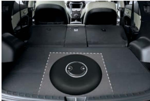
Maxi-Tank unter der Ersatzradabdeckung mit 74 Liter Bruttovolumen ermöglicht nach DIN Verbrauch > 500 Kilometer Reichweite im LPG Betrieb.
