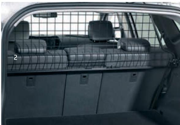
**1. Kofferraum-Trenngitter, unten.** Das Trenngitter sichert den unteren Teil des Kofferraumbereichs zum Fahrgastraum ab. Hierbei verläuft das Trenngitter an der Schräge der Rücksitzbank.
