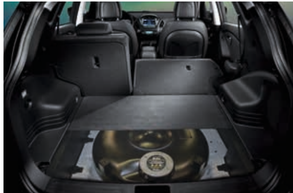
Maxi Tank unter der Ersatzrad Abdeckung mit 74 Liter Bruttovolumen ermöglicht nach DIN Verbrauch > 700 Kilometer Reichweite in LPG Betrieb.
