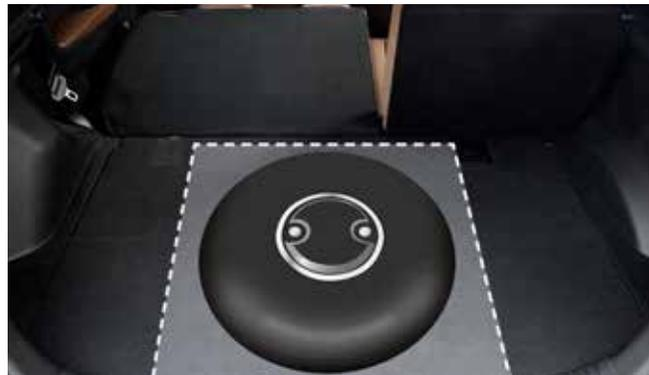
Tank unter der Ersatzradabdeckung mit 50 Liter Bruttovolumen ermöglicht nach DIN Verbrauch > 500 Kilometer Reichweite im LPG-Betrieb.
