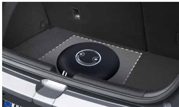
Tank unter der Ersatzrad-Abdeckung mit 65 Liter Bruttovolumen ermöglicht nach DIN Verbrauch > 550 Kilometer Reichweite im LPG-Betrieb. (schematische Darstellung)
