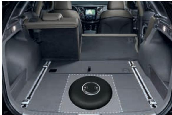
Tank unter der Ersatzradabdeckung mit 65 Liter Bruttovolumen ermöglicht nach DIN Verbrauch > 500 Kilometer Reichweite im LPG Betrieb. (schematische Darstellung)
