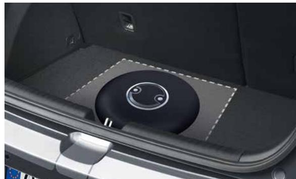
Tank unter der Ersatzrad-Abdeckung mit 59 Liter Bruttovolumen ermöglicht nach DIN Verbrauch > 500 Kilometer Reichweite im LPG-Betrieb. (schematische Darstellung)
