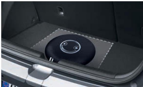
Tank unter der Ersatzrad-Abdeckung mit 47 Liter Bruttovolumen ermöglicht nach DIN Verbrauch > 500 Kilometer Reichweite im LPG-Betrieb. (schematische Darstellung)
