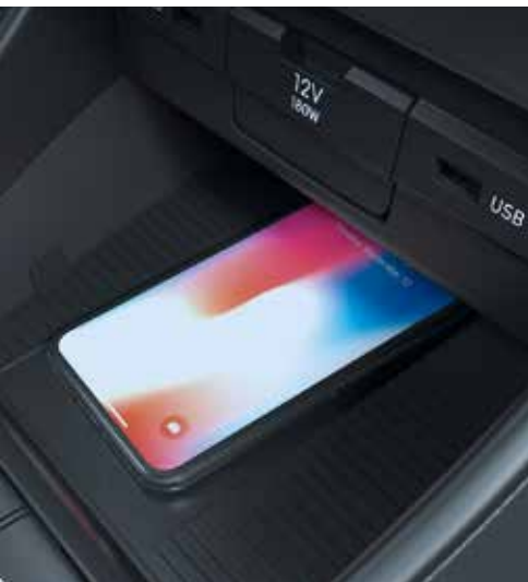
Smartphone-Ablage mit kabelloser Ladefunktion (Qi-Standard)
